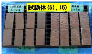
写真-2 腐食鋼板
