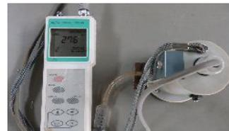
写真-5 付着塩分計測状況
