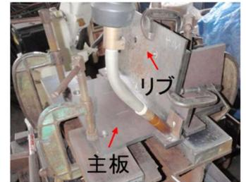
図-2 試験体製作状況
