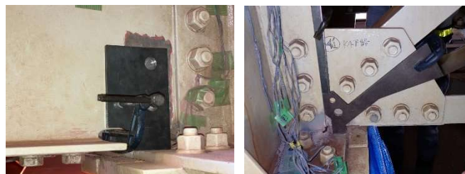
(a)フルウェブ構造用 (b)ブレース構造用 写真-2 孔明け治具
