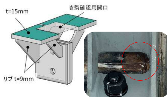
図-7 き裂確認用開口
