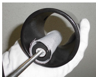
写真-2 付着塩分採取状況
