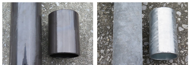
写真-6 暴露部材と新しく製作した供試体の比較例
