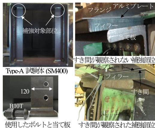
図-4 不等辺山形鋼を用いた補強
