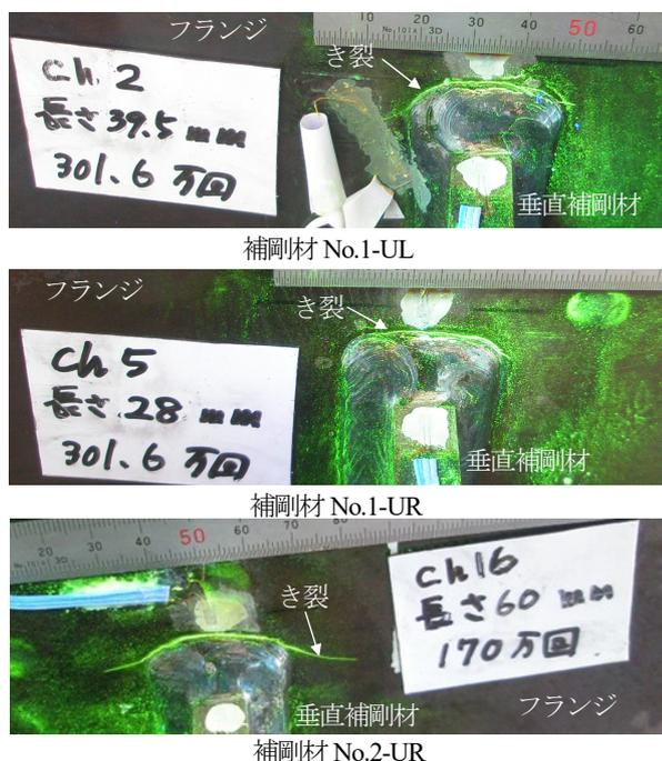
図-13 補強直前の疲労き裂の状況
